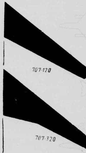
Рис. 18. Вид в плане крыльев самолетов Боинг 707-120 и 707-320
