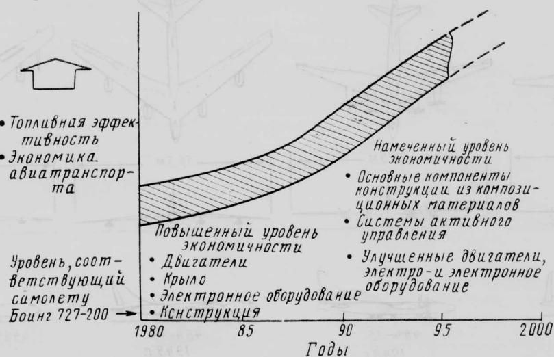
Рис. 9. Технический прогресс и повышение экономических характеристик транспортных самолетов
